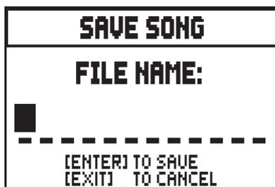
[VALUE +]/[VALUE -] ボタンで文字を選択し、[FIELD ▲]/[FIELD ▼] ボタンでカーソルを移動します。文字入力が終了したら [ENTER] ボタンを押して、ファイルを保存します。中止する場合は [EXIT] ボタンを押します。ファイルが保存されると「FILE SUCCESSFULLY SAVED」(ファイルが正常に保存されました) というメッセージが表示されます。
