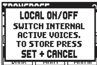
ボイスをローカルオフモードに設定するにはタブレットスイッチを押してインジケータを消します。希望する設定の状態で、[S] ボタンおよび[C] ボタンを同時に押して保存します。
