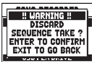
[ENTER]ボタンを押すと、録音した内容を削除して終了します。[EXIT]ボタンを押すと、SAVE画面に戻ります。
