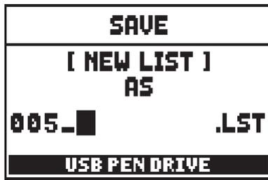
[VALUE +]/[VALUE -] ボタンで文字を選択し、[FIELD▲]/[FIELD▼] ボタンでカーソルを移動します。最初の3文字に入力できるのは数字のみです。
