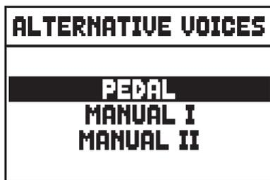
[FIELD ▲]/[FIELD ▼] ボタンで置き換えたいボイスが含まれる鍵盤セクションを選択し、[ENTER] ボタンを押します。選択した鍵盤セクション内のボイス名が表示されます。
