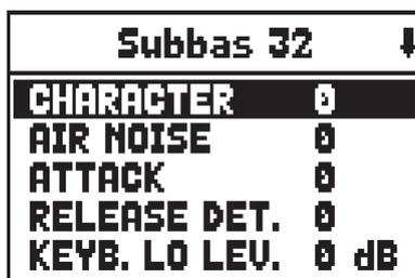
[FIELD▲]/[FIELD▼]ボタンで音量を設定したいパラメーターを選択し、[ENTER]ボタンを押します。[VALUE +]/[VALUE -]ボタンで選択したパラメーターの設定を変更します。
