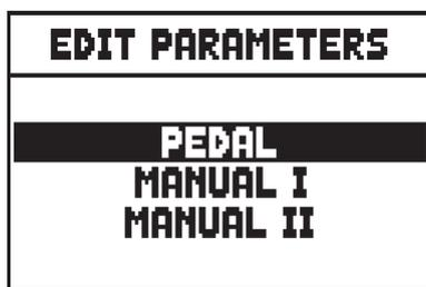
[FIELD▲]/[FIELD▼]ボタンで設定したいボイスが含まれる鍵盤セクションを選択し、[ENTER]ボタンを押します。選択した鍵盤セクション内のボイス名が表示されます。
