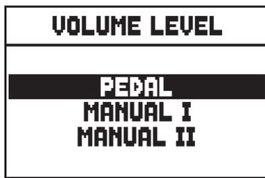
[FIELD ▲]/[FIELD ▼]ボタンで音量を調節したいボイスが含まれる鍵盤セクションを選択し、[ENTER]ボタンを押します。選択した鍵盤セクション内のボイス名と音量が表示されます。
