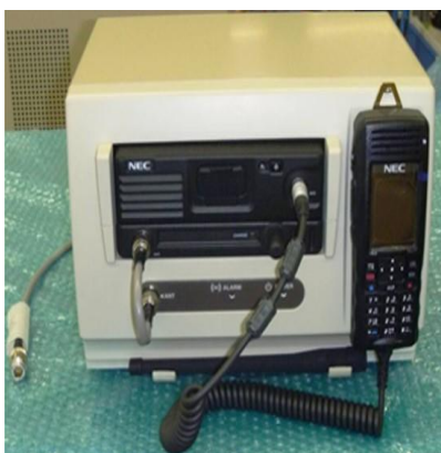
防災無線（半固定系）
