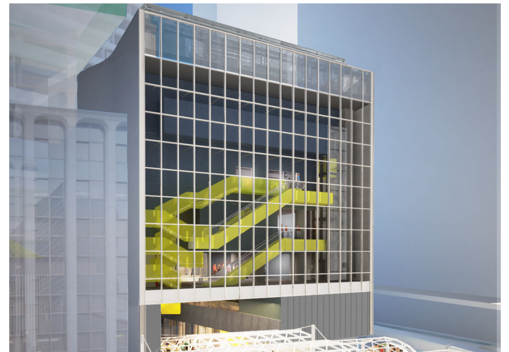
国道 246 号側に 20m の吹抜空間をつくり、エスカレーター、階段、エレベーターの垂直動線で人の動きを視覚化し賑やかな雰囲気渋谷に対して表出させた。
