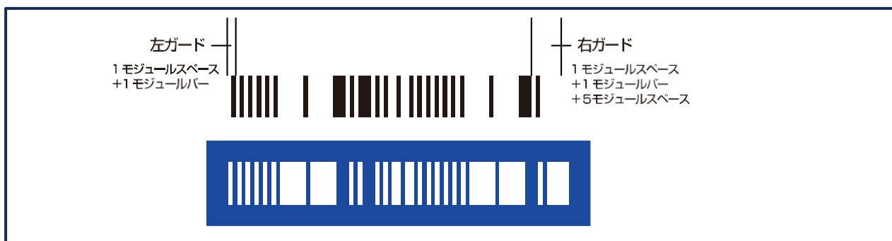
参考 3 : GS1 データバー合成シンボル CC-A におけるクワイエットゾーンとガードパターン
