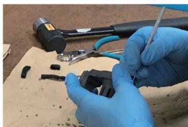
SLM方式で造形したモデルは固まっていないモデル材(粉末)に覆われているので取出し後に残った粉は専用の機械で吸引します。
