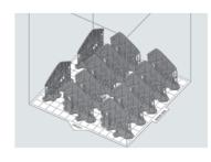
光造形方式では樹脂の中でモデルとプラットフォームを繋ぐ足場のようにサポートが構築されます。モデルを重ねるとその上にサポートが造形されてしまうので平置き配置のみとなります。
