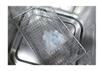
光造形方式で造形したモデルはUV硬化樹脂で覆われているため、まず溶剤で洗浄します。必要に応じて二次硬化を行います。
