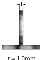
"支えられていない壁" とは1つの側面のみが他の壁に接続されている壁のことを言います。
