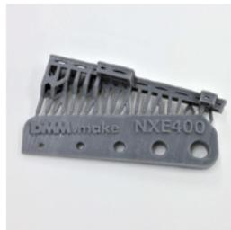
形状によってはモデルを回転させ、造形に最適な箇所にサポートが付くように配置しておりますが、ご希望の造形方向と異なる可能性があることをご了承ください。
