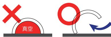
中空形状やカップ形状は平置きすると造形中に真空が発生し造形不良の原因となります。斜めに配置することで解消しますが、複合的な要因により適切な配置ができない形状の場合は造形をお断りさせていただく場合があります。
