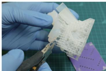
光造形方式で造形したモデルはUV硬化樹脂で覆われているため、まず溶剤で洗浄します。必要に応じて二次硬化を行います。
