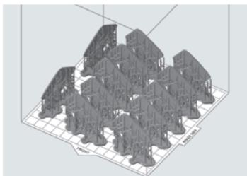
光造形方式では樹脂の中でモデルとプラットフォームを繋ぐ足場のようにサポートが構築されます。モデルを重ねるとその上にサポートが造形されてしまうので平置き配置のみとなります。
