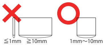
ソリッド形状は造形中にトラップが生じる可能性が高く、トラップが生じた場合モデルが崩れてしまいます。
