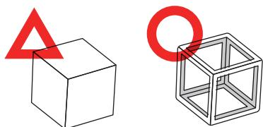
NXE400は吊り下げ方式のため、比容積が大きな造形物は自重により変形するリスクが高まります。また造形価格も上がります。
