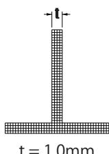
"支えられていない壁"とは1つの側面のみが他の壁に接続されている壁ことを言います。
