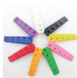
ABS ライク | MJT | J750 は標準的な ABS プラスチックに近く、耐衝撃性と衝撃吸収性に優れた ABS ライク素材です。
