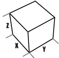
$X + Y + Z \geq 10\text{mm}$
