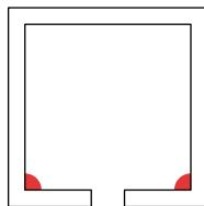
モデル内にある空洞部分には固いゼリー状のサポート材が付着しますが、出荷前にそれらをすべて手加工で取り除いています。よって形状的にサポート材を取り除けないモデルの場合は造形が出来ません。
