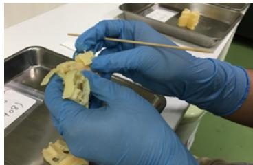
インクジェット方式のサポートは、マテリアルとは異なる融解性のサポート材で造形されます。造形後は手作業による荒取り後、サポートの材質に合わせ恒温槽や溶解液で大まかに溶かします。融解の際は変形や歪みが起こりやすいので注意が必要です。
