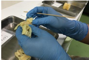
インクジェット方式のサポートは、マテリアルとは異なる融解性のサポート材で造形されます。造形後は手作業による荒取り後、サポートの材質に合わせ恒温槽や溶解液で大まかに溶かします。融解の際は変形や歪みが起こりやすいので注意が必要です。
