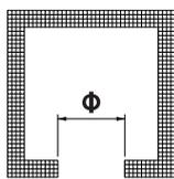
$\Phi \geq 10\text{mm}$
