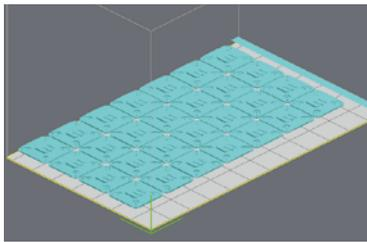
インクジェット方式ではモデル下部にサポートが造形され、機種によってはサポート付着面の美観が損なわれます。モデルを重ねるとその上にサポートが造形されてしまうので平置き配置のみとなります。
