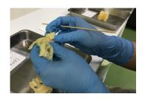
インクジェット方式のサポートは、マテリアルとは異なる融解性のサポート 材で造形されます。造形後は手作業による荒取り後、サポートの材質に合わ せ恒温槽や溶解液で大まかに溶かします。融解の際は変形や歪みが起こり やすいので注意が必要です。
