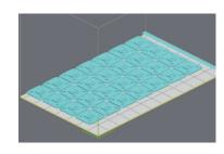
インクジェット方式ではモデル下部にサポートが造形され、機種によってはサポート付着面の美観が損なわれます。モデルを重ねるとその上にサポートが造形されてしまうので平置き配置のみとなります。
