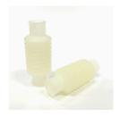
反りの抑制や表面状態の均一化のため造形時に「シェル(バリのような形状)」 が造形 されます。シェルは後処理時に除去しますが、形状によっては取り切れない可能性 があります。
