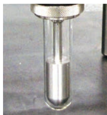
低粘度液体の測定に 有利な外筒回転方式
